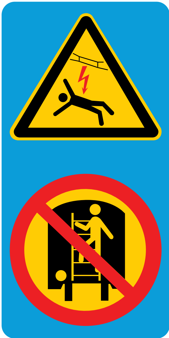
Kuva 23. Kiipeäminen kielletty ajolangan alla – turvallisuusmerkintä /EN 15877-1:2012+A1:2018
