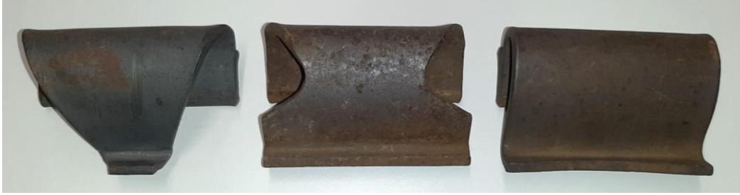
Kuva 11.6:4. Hey-Back-kiskonkiinnitykset. Vasemmalla J7-, keskellä J8- ja oikealla J9-jousi.
