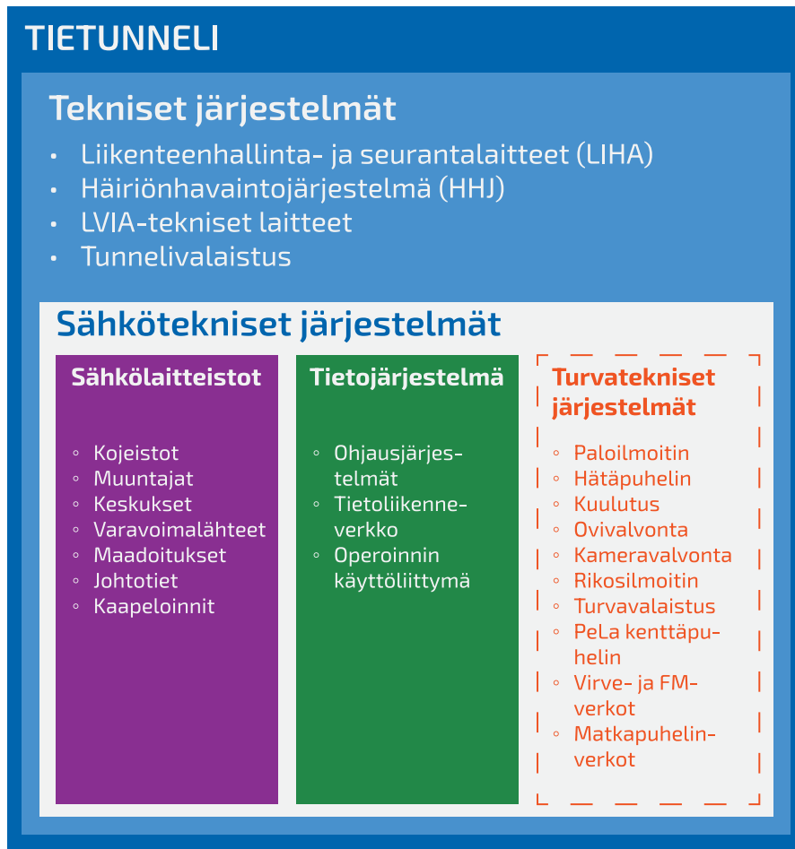
Kuva 1. Tietunnelin sähkötekniset järjestelmät.
