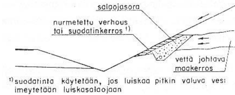
Kuva 31. Luiskasalaoja, joilla torjutaan luiskien syöpymistä.
