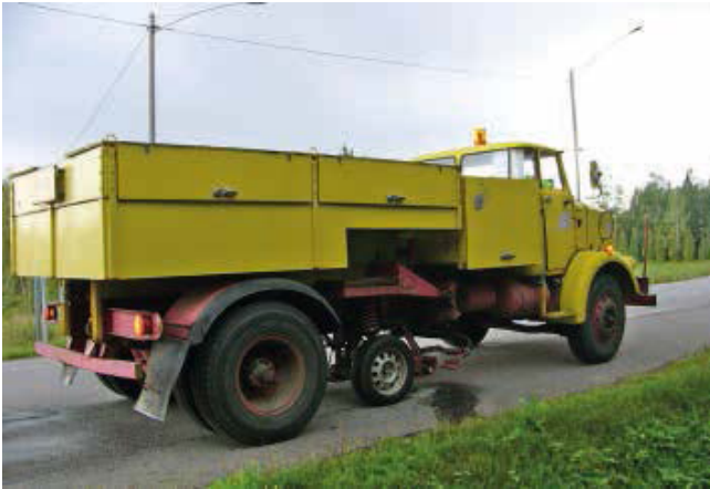
Kuva 25. Hyväksytty uuden asfalttipäällysteen kitkanmittauslaite Kitka-Sisu
