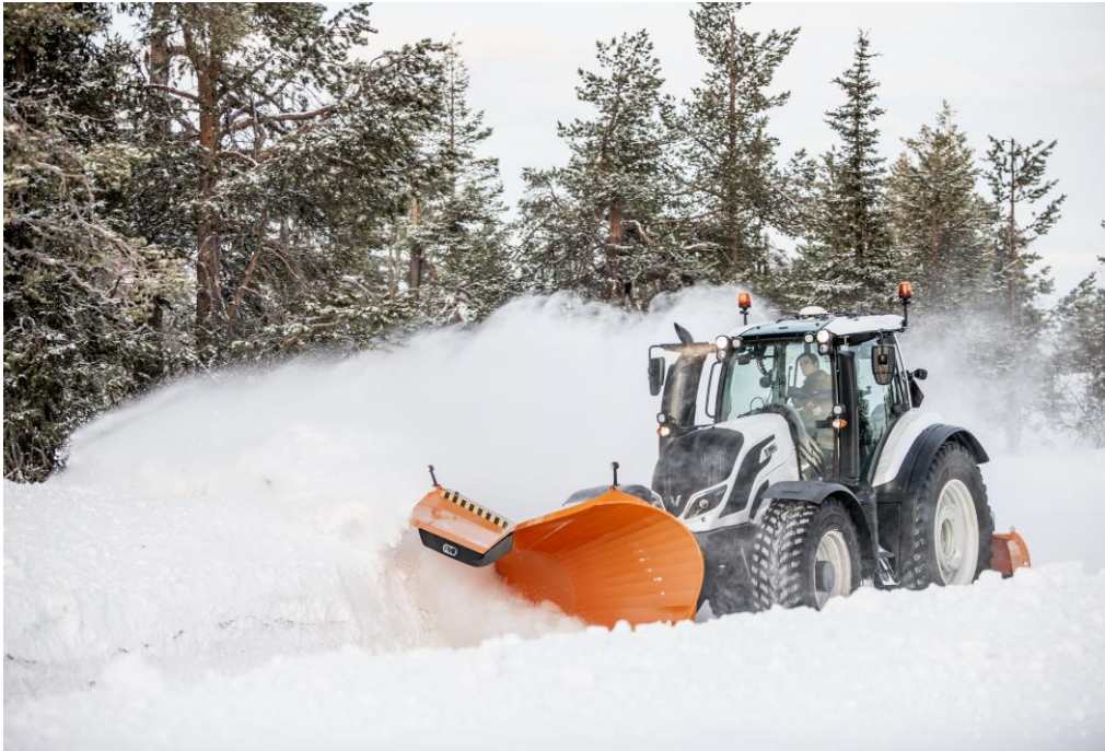
Kuva 13. Traktori varustettuna pitävillä palakuvioituilla renkailla.
