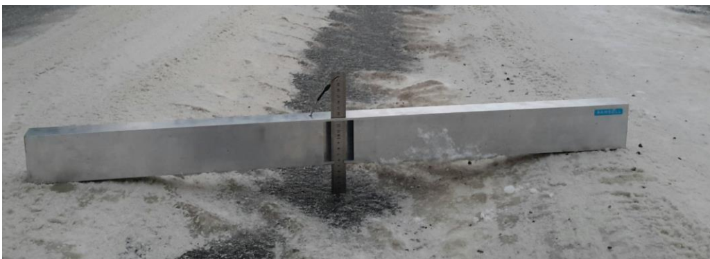
Kuva 8. Polanneuran syvyyden mittaamisessa käytettävä metrin oikolauta.
