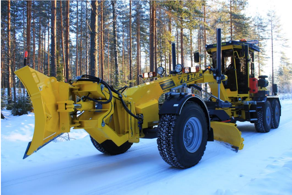
Kuva 16. Tiehöylää tarvitaan jäisen polanteen poistossa.
