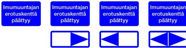
Kuva 12.15:1 Imumuuntajan erotuskenttä päättyy
