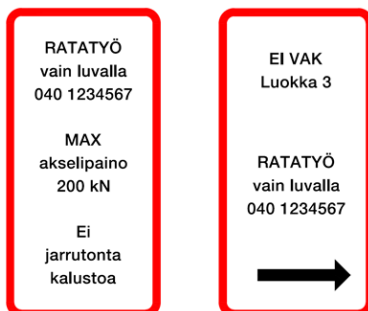
Kuva 17.5:47. Esimerkkejä Vaihto- ja ratatyön rajoite -merkistä, joissa merkissä esitettäviä tietoja on yhdistetty.
