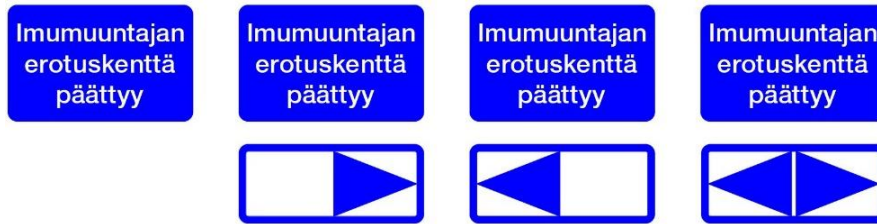
Kuva 17.8:44. Imumuuntajan erotuskenttä päättyy -merkki.
