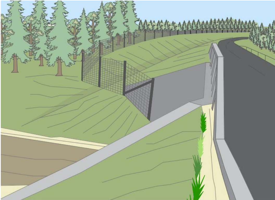
Kuva 9. Esimerkkiratkaisu riista-aidan päättämisestä kehäsillan siipimuriin alikulun kohdalla. Aidan viimeinen pylväsväli tuodaan mahdollisimman lähelle siipimuuria ja tuetaan vinotuella.
