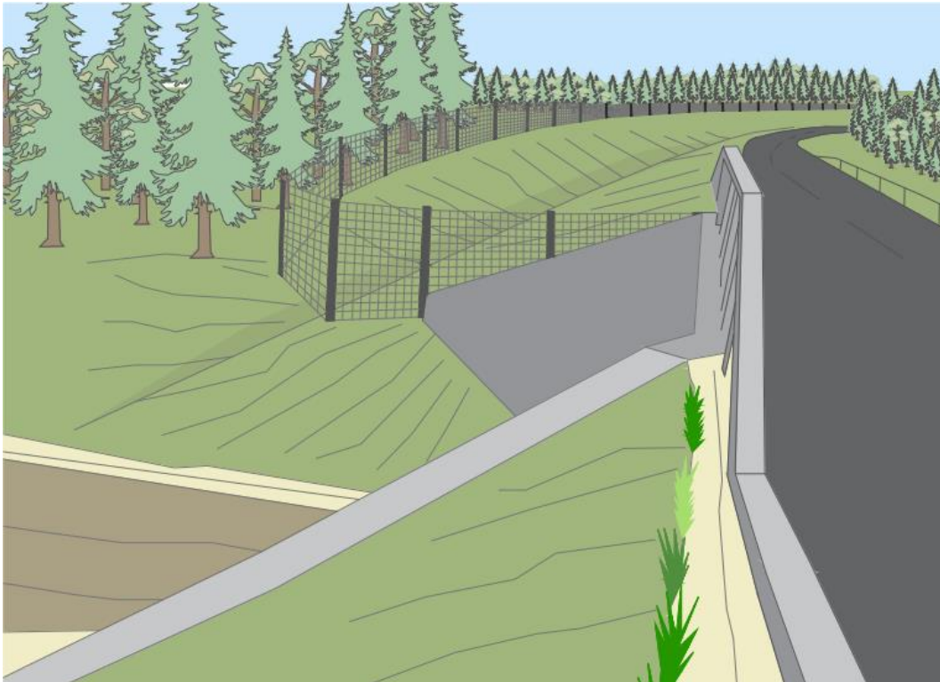
Kuva 10. Vaihtoehtoisesti riista-aita voidaan jatkaa madallettuna kehäsillan siipimuurin takareunaa mukailleen ja kiinnittää lyhyeen päätypylvääseen muurin päällä.
