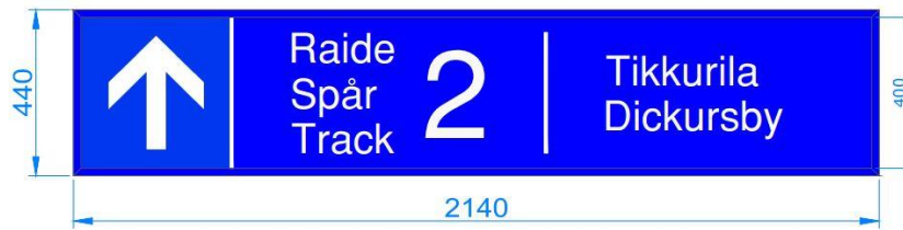
Kuva 31. Yksirivinen 440 mm korkea suuntaopaste.
