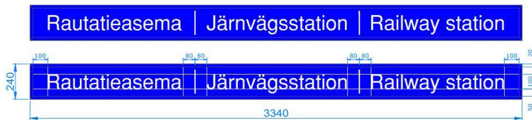
Kuva 5. Rautatieasemaopaste 240 mm korkealla mitoituksella.
