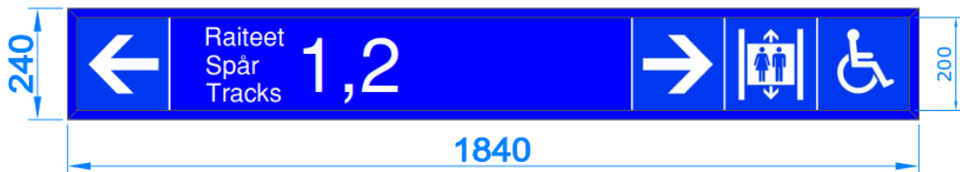
Kuva 29. Yksirivinen 240 mm korkea suuntaopaste, tapaus 2.
