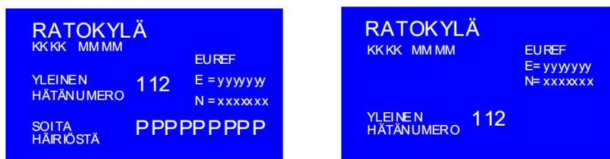
Kuva 2. Tasoristeyksen lisäkilpi. Kilven yläreunassa isolla tekstillä tasoristeyksen nimi, jonka alapuolella ratakilometri.
