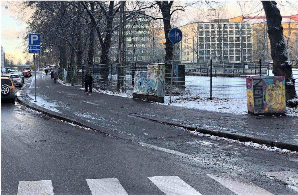
Kuva 196 Pyöräkaistan ja pyörätien saumakohdalla siirtyminen toteutetaan riittävän pitkän siirtymäluiskan avulla (kuva Niko Palo).
