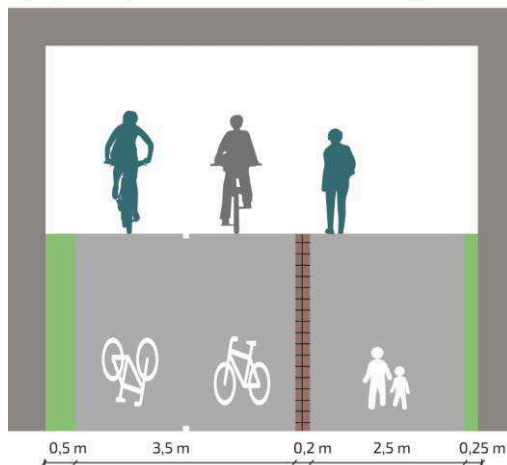
Kuva 164 Esimerkki alikulun leveyden mitoituksesta.
