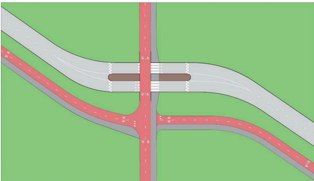
Kuva 158 Väistämisvelvollisuus pyöräilijän tienylityspaikassa (B7) -liikennemerkillä voidaan osoittaa vain rakenteellisesti korotettu pyörätien jatke.
