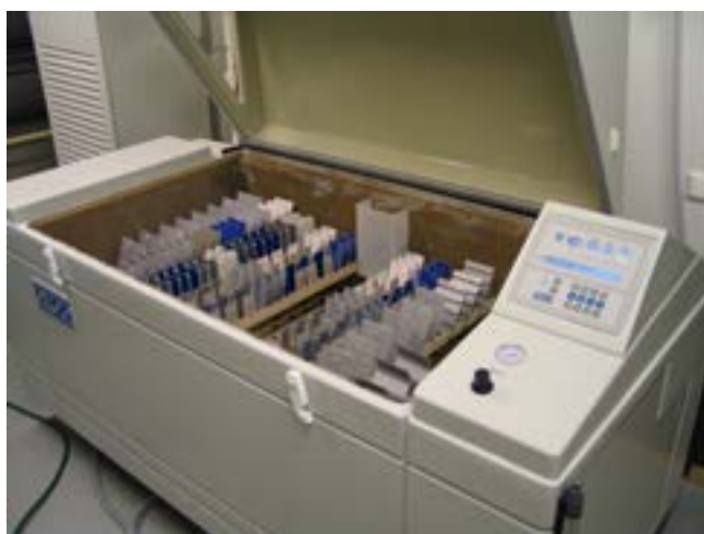
Kuva 2. Maalausjärjestelmän testauksessa käytettävä korroosiotestilaite.
