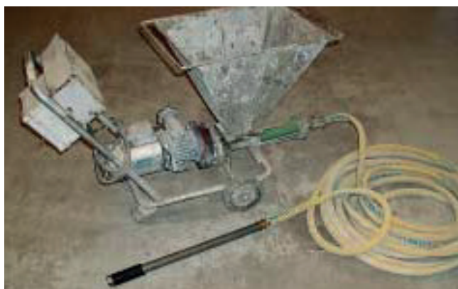
Kuva 2. Sementti-injektointipumppu ja injektointitulppa.
