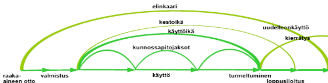
Kuva 1. Elinkaari, sen vaiheet ja käyttöikäkäsitteitä infrarakentamisessa / 27 /.
