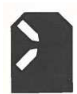
Kuva 4. Vaihteen V111 asennonosoitin a/b-päästä katsottuna
