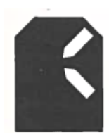
Kuva 5. Vaihteen V111 asennonosoitin c/d-päästä katsottuna
