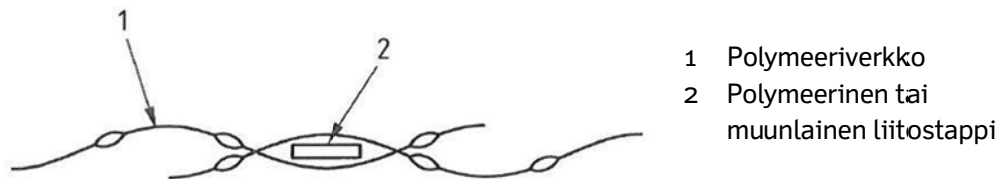
Kuva 2.11 Jäykkänurkkaisen verkon tappiliitos (BS 8006-1:2010).
