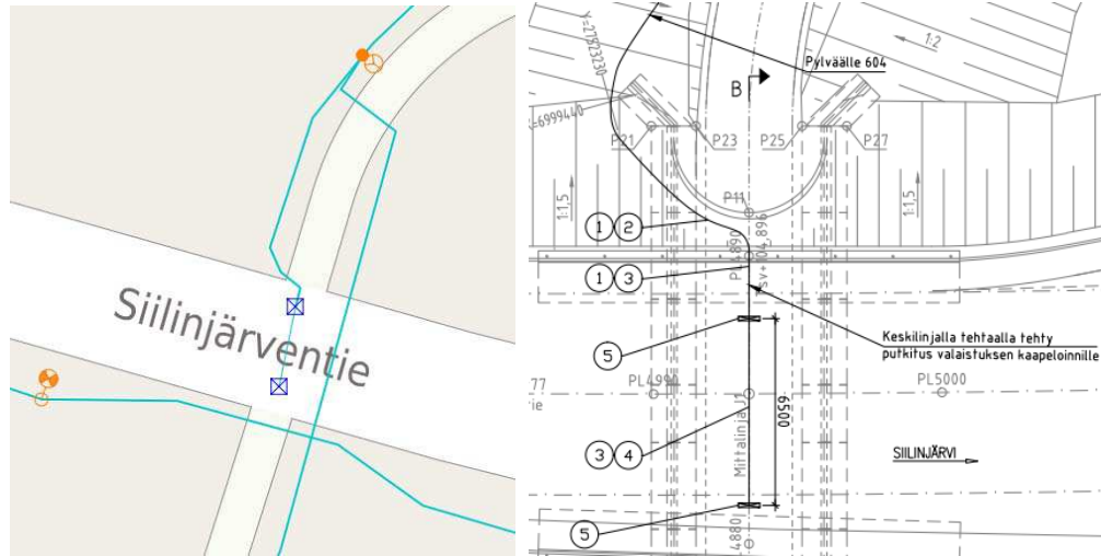
Kuva 3. Keskimmäistentien alikulun sillanalusvalaistus. Vasemmassa kuvassa on esitetty digitoitu valaistus ja oikeassa kuvassa ote alikulun valaistuksen rakennussuunnitelmasta.
