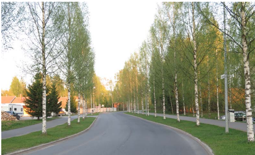
Kuva 58. Esimerkki puukujanteen käytöstä kokoojakadun hidastavana elementtinä.
