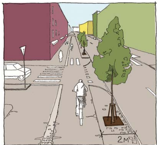
Kuva 68. Jalkakäytävä ja pyörätie ovat lähes kiinni ajoradassa.
