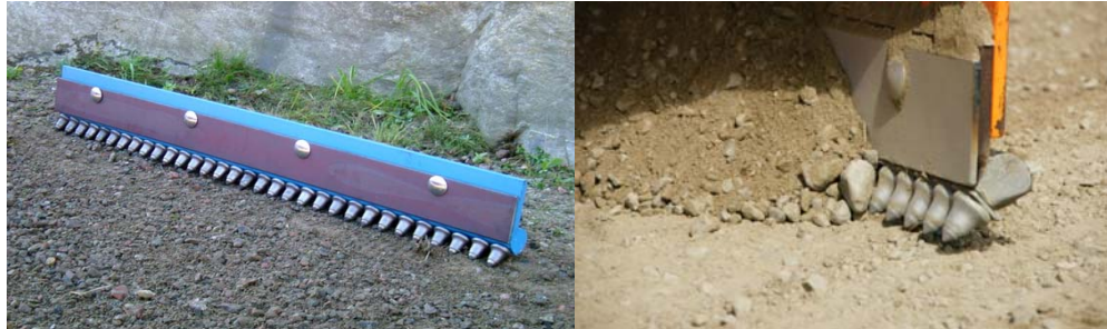
Kuva 27. Tappiterällä on parhaat leikkaavat ominaisuudet.
