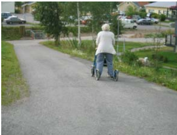
Kuva 13. Rollaattorilla voi myös lasketella mäkeä, jos se ei ole liian jyrkkä, ja jos kunto kestää. Liikkumisrajoitteisten kannalta suositellaan, että pitiuskaltevuus ei ylitä 4 prosenttia.
